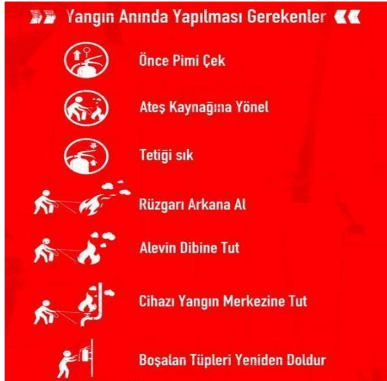
Şekil 14. 4. Yangın Anında Yapılması Gerekenler
