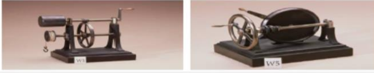
Eksenleri birbirine paralel ve dik olan sürtünmeli çarklar
