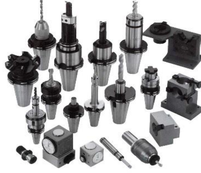
CNC tezgâhı ve örnek kesici takımlar
