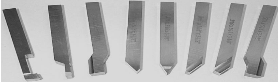
Tornalamada Kullanılan Kesici Takımlar
